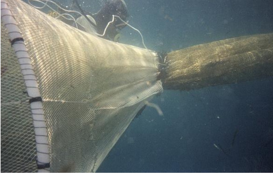
Şekil 4. Trol örtü torbasının torbadan ayrılması
